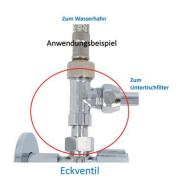
Für den Anschluss des Untertischfilters an einen zweiten Wasserhahn: Mitgeliefertes T-Stück auf das Eckventil aufsetzen, den vorher gelösten Anschluss-Schlauch wieder oben auf dem T-Stück montieren
