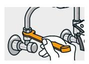
Kaltwasserleitung am Eckventil schließen, vorhandenen Anschluss-Schlauch lösen – ggf. tritt ein wenig Wasser aus, das noch im Anschluss-Schlauch steht! Wischtuch und Schale bereit halten
